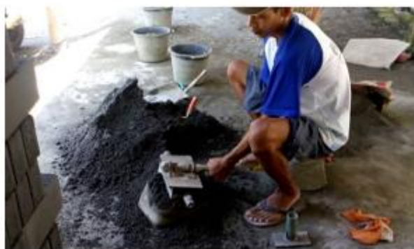
Gambar 7. Cetakan paving blok dan Pembuatan paving
