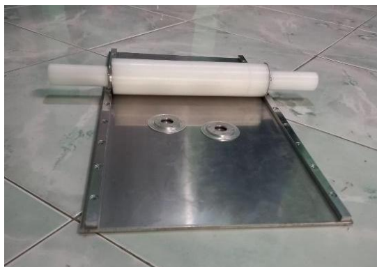
Gambar 8. Alat cetak samiler dengan penyempurnaan
