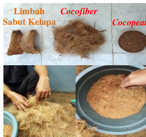
Gambar 6. Hasil pengolahan limbah sabut kelapa menjadi cocofiber dan cocopeat .
