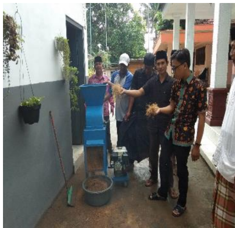
Gambar 5. Proses penguraian limbah sabut kelapa secara mekanis menjadi cocofiber dan cocopeat .
