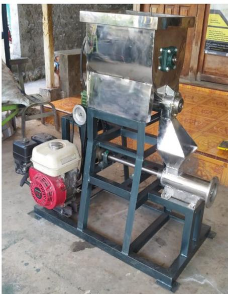
Gambar 2 Mesin Penggiling dan Granulator Oyek
