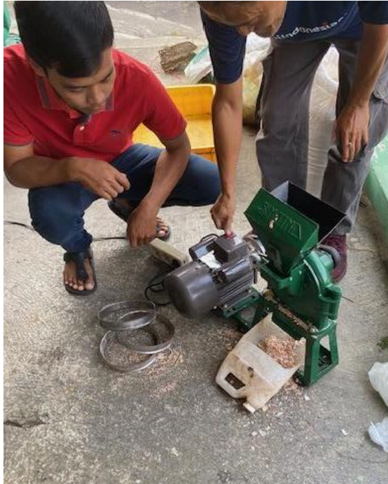
Gambar 8. Proses pengujian mesin penepung cangkang telur
