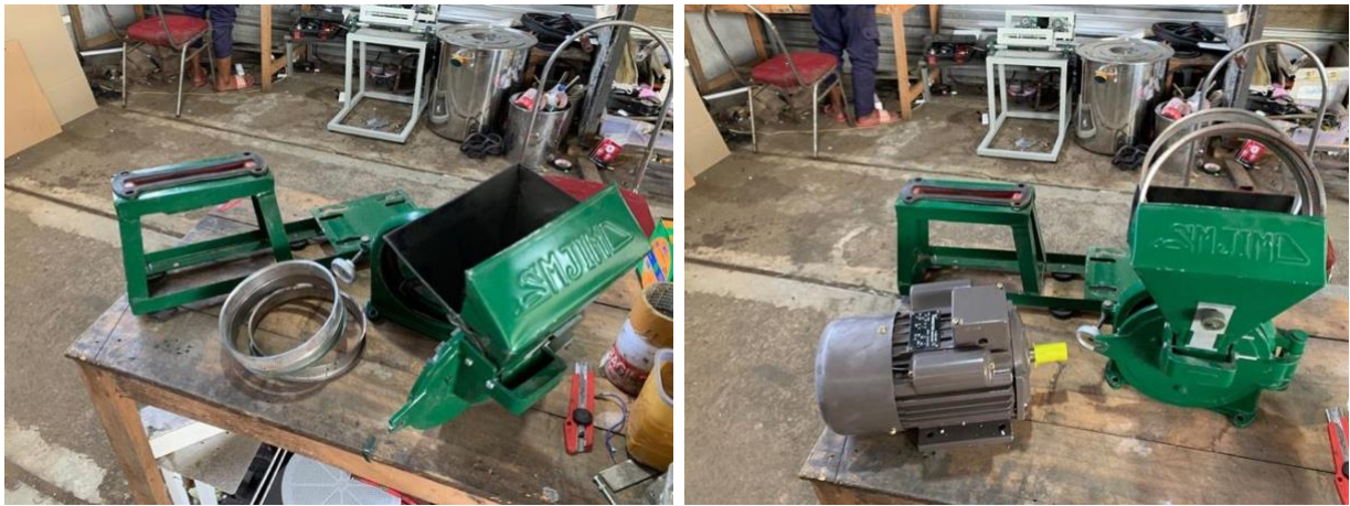
Gambar 5. Perakitan komponen mesin penepung cangkang telur
