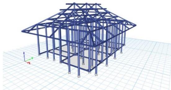
**Gambar 18.** Desain Konstruksi Rumah dengan Material Bambu (Sumber : Modeling Aplikasi SAP 2000, 2023)
