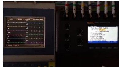
Gambar 5a. Uji Fungsi Pesawat EKG 1 dengan 80 Bpm (Sumber : Dokumentasi, 2023)
