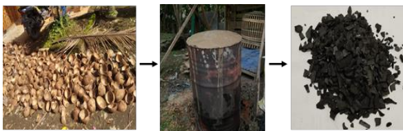
Gambar 5. Proses pembuatan arang dari tempurung kelapa
