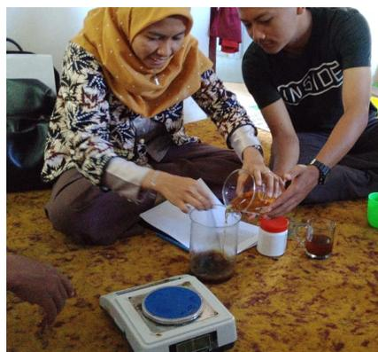
Gambar 3. Pencampuran NaOH, kopi dan jelantah
