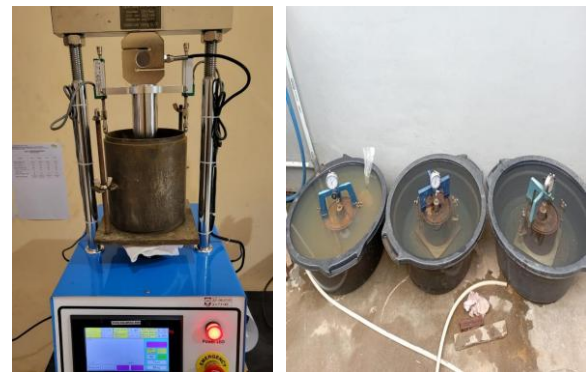
Gambar 6. Pengujian CBR Rendaman
