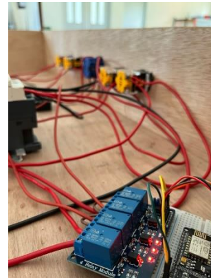
Gambar 8. Selector switch terhubung dengan relay arduino
