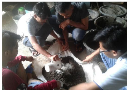
Gambar 4. Proses pencampuran atau pengadukan bahan baku batako
