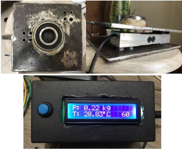
Gambar 4 Desainudukan untuk sensor tekanan dan kotak mikrokontroler.
