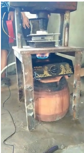
Gambar 6. Proses pengujian alat saat produksi karet perapat pada tekanan dan suhu tinggi.
