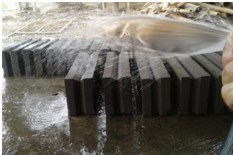
Gambar 7. Tindak lanjut perawatan batako dengan disiram setiap hari
