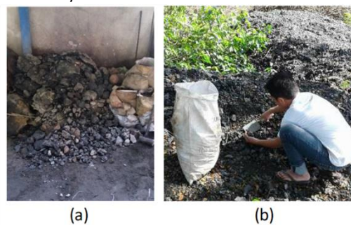
Gambar 2. Terak tanur kupola (a) di CV Cipta Guna Lestari dan (b) yang sudah dibuang di sawah
