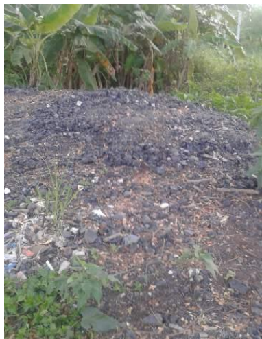
Gambar 1. Terak atau limbah peleburan tanur kupola yang telah dibuang di area kebun atau sawah
